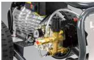
Nuevas bombas CL3.8 y CL 6.0 autocebantes de tres pistones de cerámica integral, doble visor de aceite y cabezal de latón. Nueva válvula de regulación de presión embreadada L3.1, pasos internos redimensionados para garantizar su correcto funcionamiento incluso en condiciones de altos caudales de funcionamiento
